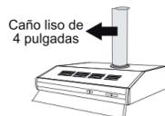
Utilizar codos y conductos lisos (no corrugados) de PVC o zinc de 100 mm. (4 pulgadas). Procure sellar las uniones correctamente para evitar pérdidas por fuga. Reducir en lo posible el número de curvas en la instalación. Cada una de ellas reduce la eficiencia del equipo.
