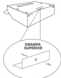
En ambos equipos después de colgar el aparato, colocar la **GRAMPA SUPERIOR** con un tarugo y tornillo. La misma evitará el desplazamiento vertical.
