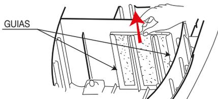
**Filtro salida de aire:** Deslice la traba J y retire el filtro como se muestra en la imagen. Realice el proceso inverso para colocarlo nuevamente.
