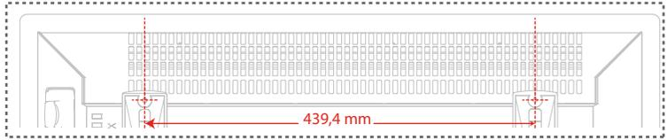
En la parte posterior del equipo, identifique los alojamientos para el soporte pared. De fábrica, estos alojamientos vienen cubiertos con una superficie plástica que debe ser retirada del equipo. Para ello, corte las uniones con la ayuda de una trincheta teniendo la precaución de que esta pieza no caiga al interior del equipo. **No inserte los dedos ni otros elementos extraños a través del orificio.**
